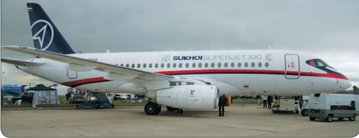
Sukhoi Superjet 100 — российский ближнемагистральный пассажирский самолет. Рассчитан на перевозку до 98 пассажиров на расстояние до 4400 км
