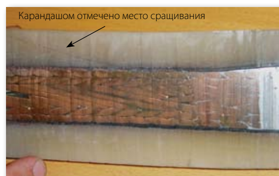
Место соединения кабеля практически не отличается от диаметра самого кабеля
