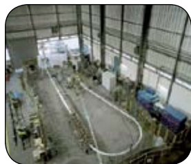
Рис. 4. Испытательный стенд с ВТСП кабелем компании Pirelli, Милан.
