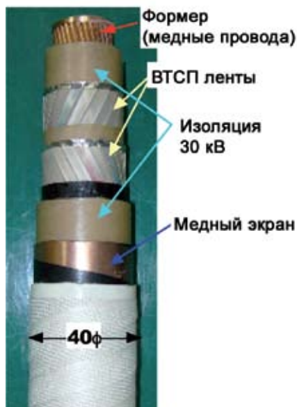
Рис. 35. Конструкция ВТСП кабеля постоянного тока 20 кВ Chubu University
