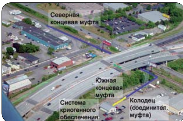
Рис. 12. ВТСП КЛЭП 34,5 кВ (длиной 350 м) SEI в г. Олбани, США
