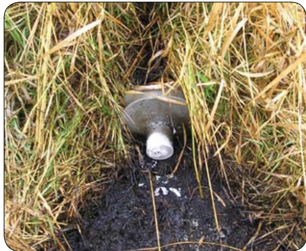
Пробитый изолятор ШПУ-10 со следами оплавления сердечника и юбок
