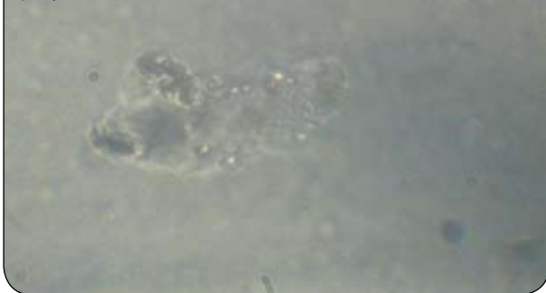
Рис. 6. Неоднородность изоляции, вызванная неполным расплавлением гранул полиэтилена
