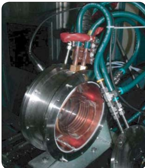
Рис. 8. Электропечь, используемая в методе FCVD
